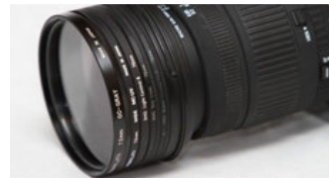
Kaskadowe łączenie filtrów
